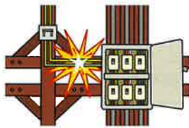
電気配線工事において、 工事期間中の作業の欠陥により、 引渡し後 1 か月目に受電盤が発火し、 焼損した。
