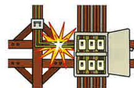
電気配線工事において、 工事期間中の作業の欠陥により、 引渡し後1か月目に受電盤が発火し、 焼損した。
